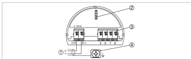
Отсек электроники и подключения (однокамерный корпус)
